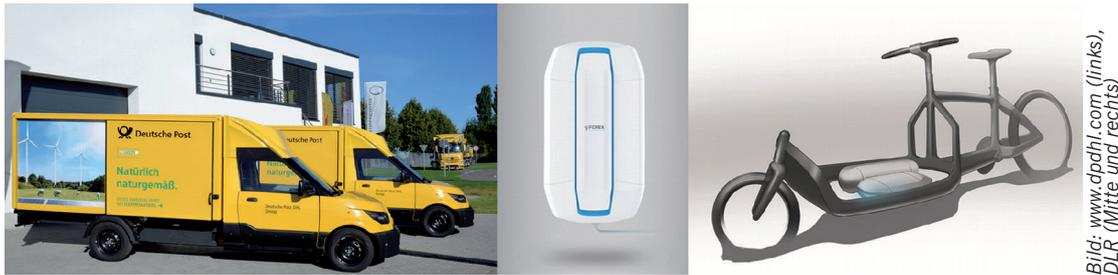
**Bild 7** StreetScooter Work L (links) und Fuel Cell Range Extender (FCREX) für Lastenfahrräder (Mitte und rechts).
